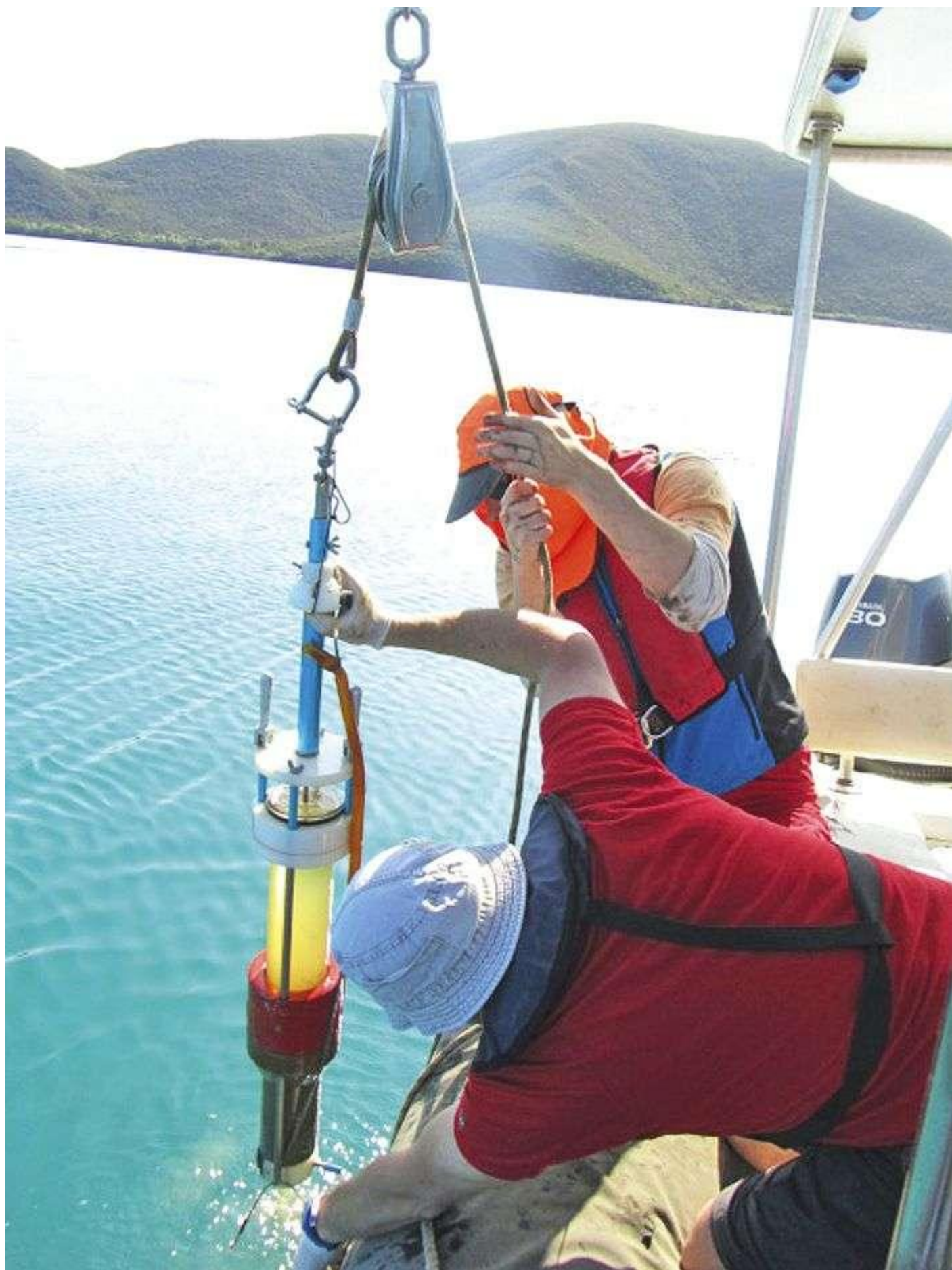
Les scientifiques font des prélèvements de sédiments du lagon à l'aide d'un carottier lesté qui se bouche automatiquement de manière à emprisonner le sédiment pour le remonter. Photo IRD Crée le 05.12.2016 à 04h25 Mis à jour le 05.12.2016 à 04h25
