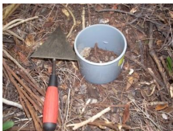
Figure 29. Matériel utilisé pour les prélèvements de topsoils (Cylindre PVC et truelle de maçon)
