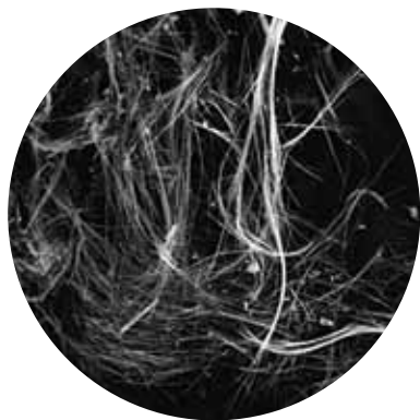
Faisceaux souples de trémolite-amiante vu au microscope électronique (échelle = 100µ).
