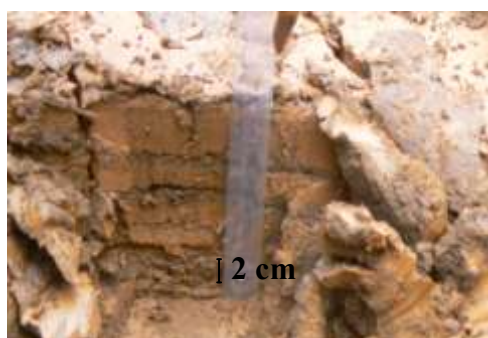
Figure 22 : Observation de l'alternance de couches claires et sombres pour le prélèvement au centre de SW34 (Koniambo).
