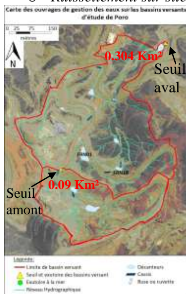
Figure 15 : Ecoulements superficiels préférentiels et tailles des sous-bassins Amont et Aval du bassin-versant minier Denise, mine de Poro, source : A. GUYONNEAU (2012).
