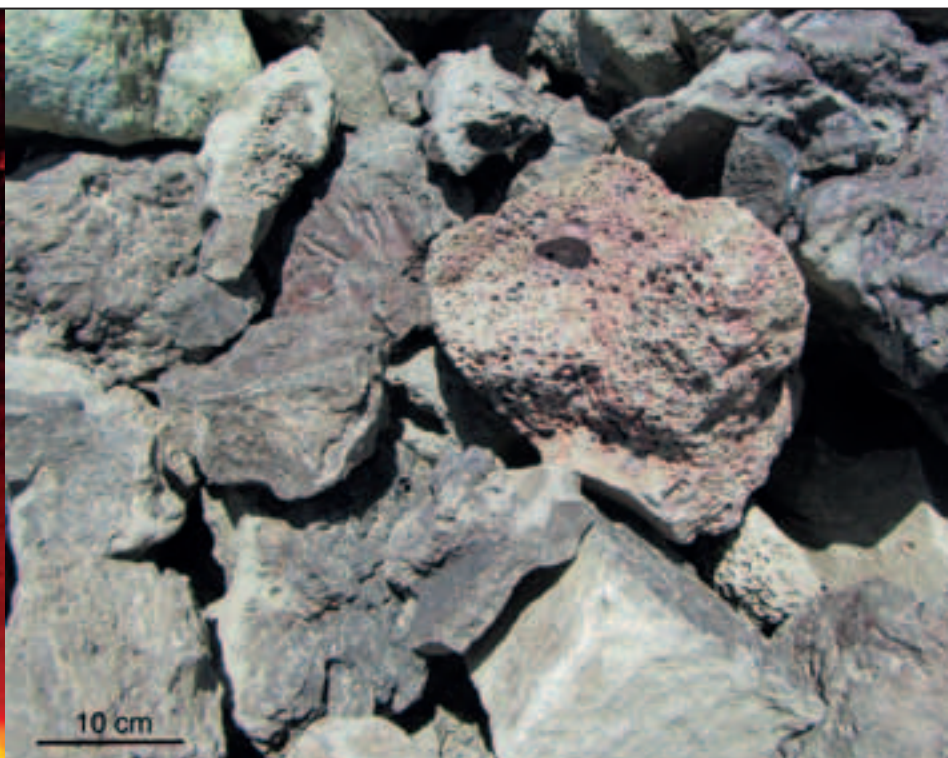
Si, à la SLN, les scories en fusion sont plongées dans de l'eau de mer, celles de KNS sont déversées en plein air. Elles ont donc des propriétés différentes, mais ont la même capacité à absorber le CO 2 .
