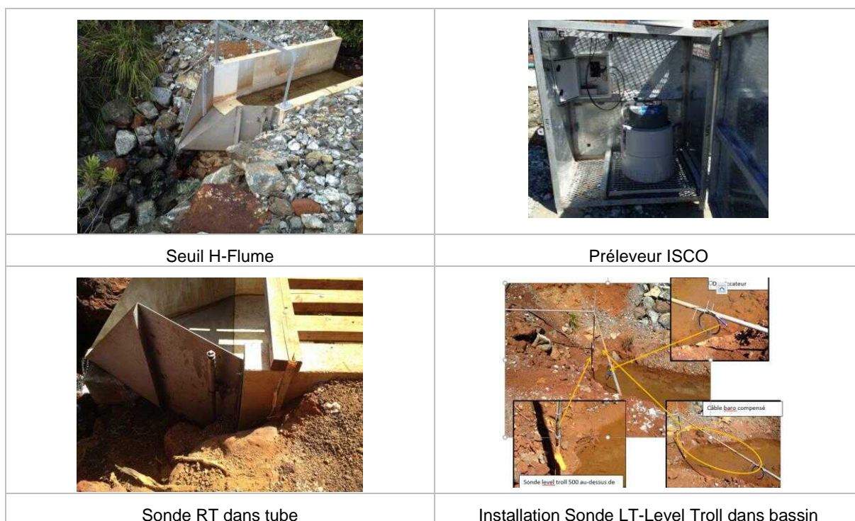
Figure 2 : équipements présents sur certaines stations de suivi des eaux
