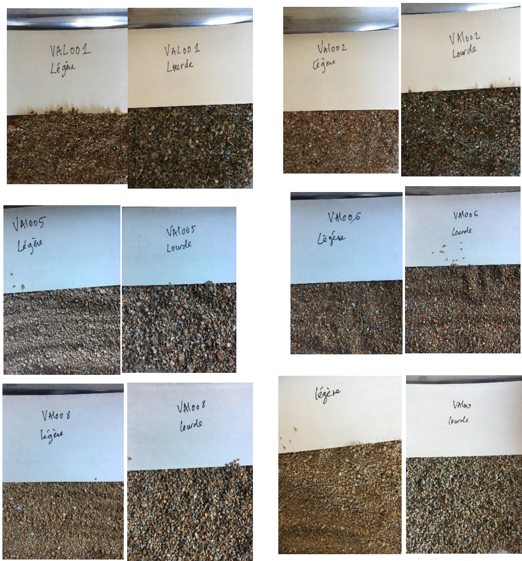
Figure 38: Les couches de lit de minerais séparées après jiggage.
