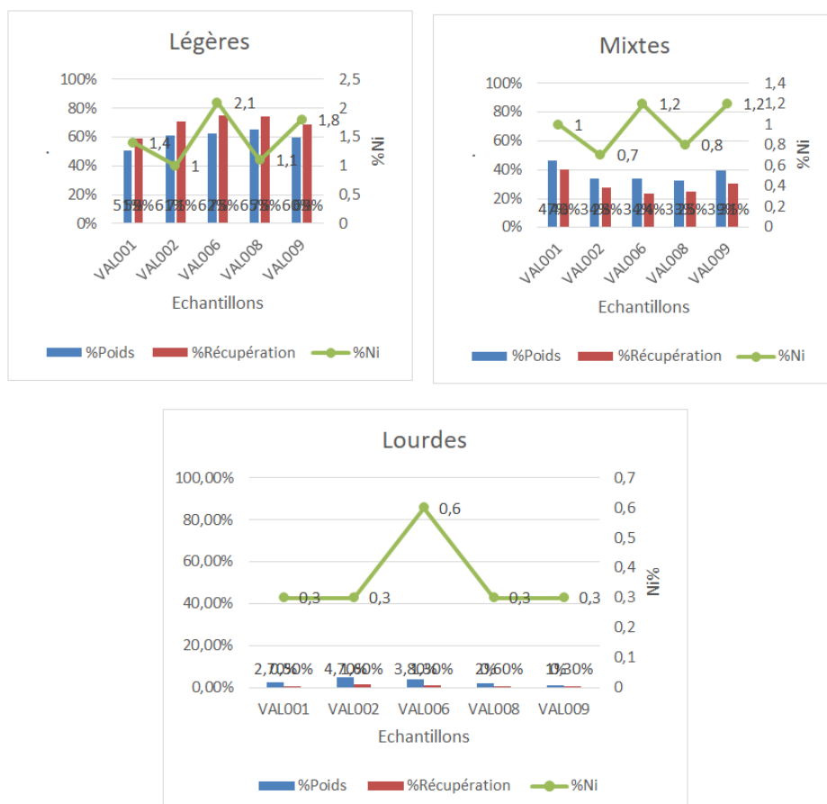
Figure 41: Récupérations et teneurs produits table à secousse
