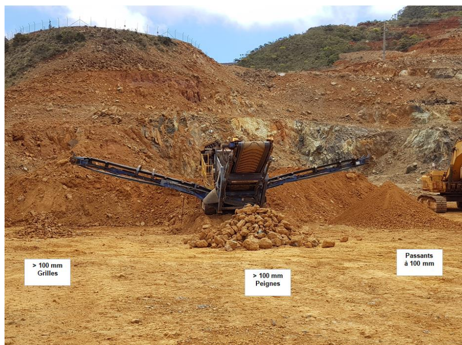
Figure 16: Refus et passant du crible FINTEC 640
