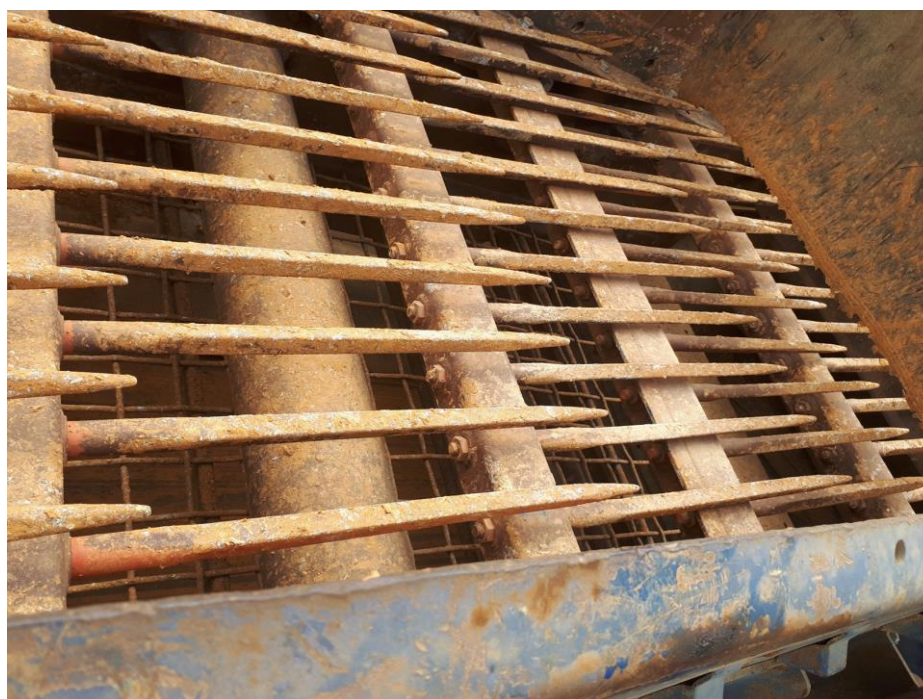
Figure 15: Peignes et grilles (100mm) du crible FINTEC 640.
