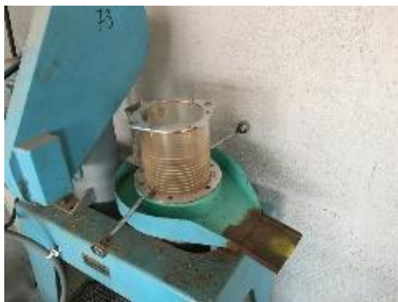
Figure 34: JIG mécanique utilisé pour les essais
